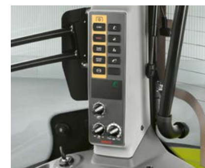
Zapfwellengeschwindigkeiten und elektronische Heckkraftheberregelung am B-Holm einstellbar.
