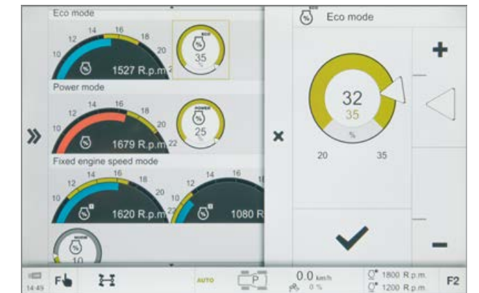
Einstellung der Motordrehzahl für „Eco“ und „Power“, sowie den Motordrehzahlspeicher
