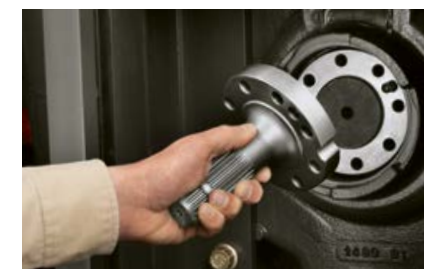
Einfacher Wechsel der Zapfwellenstummel.
